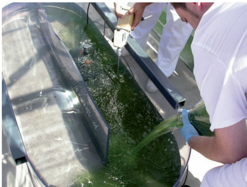
Figura 5. Inoculación de los cultivos al aire libre de 400 litros.
